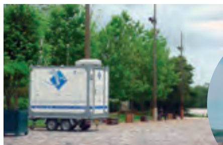
Système mobile et tubes de mesure de la pollution atmosphérique
