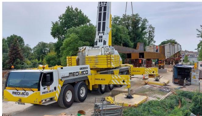
+ Utilisation d'une grue mobile d'une capacité de charge de 160T
