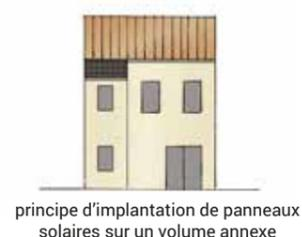
principe d'implantation de panneaux solaires sur un volume annexe
