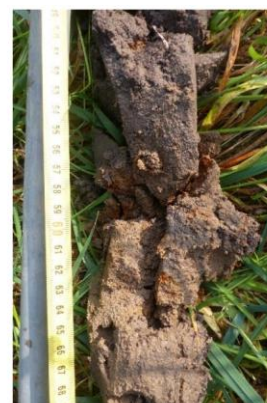
Traces d'oxydation (Sondage S4)
