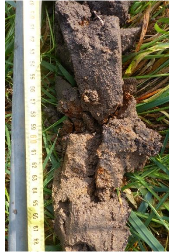
Traces d'oxydation (Sondage S4)
