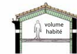
isolation sous toiture
